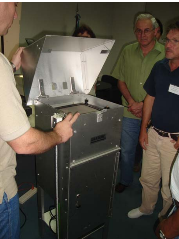
Equipo para medir partículas totales en aire. Programa Calidad del aire.
